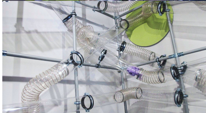
inspirace - exponát „potrubní pošta“ posouvání předmětu potrubím za přispění proudění vzduchu
